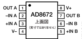
図3. 8ピンSOIC (接尾文字：R)
