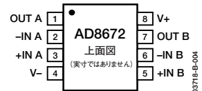
図4. 8ピンMSOP (接尾文字：RM)
