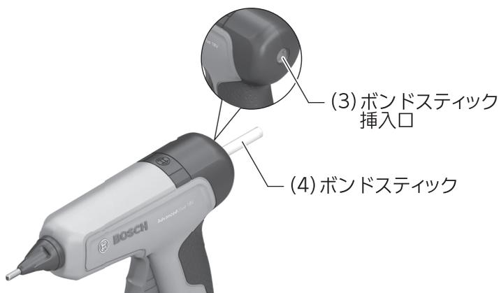
☞ 一度電動工具本体に挿入したボンドスティック(4)は、引き抜かないでください。引き抜けない構造になっていますので、無理に引き抜くと、故障の原因になります。
