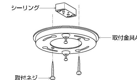
※取付金具Aを取付ける方向により、本体(スライドコンセント)の方向が決まります。
