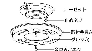
取付金具Aを回転させ、止めねじを締め付けて取付ける。
