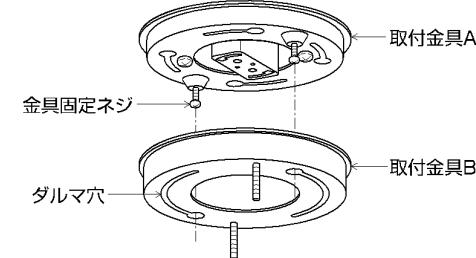
取付金具Bを回転させ、金具固定ネジで締め付けて取付ける。
