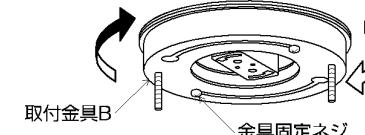
※取付金具Bの取付位置により、本体(スライドコンセント)の方向を約90°調整できます。
