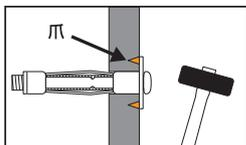
φ9mmのドリルであけた下穴に本製品を差し込み、爪が壁にささるまで軽く叩き込みます。
