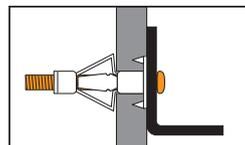
ねじを抜き取り、取付物の上からねじを締め付けて完了です。(ねじの締めすぎにご注意ください。)
