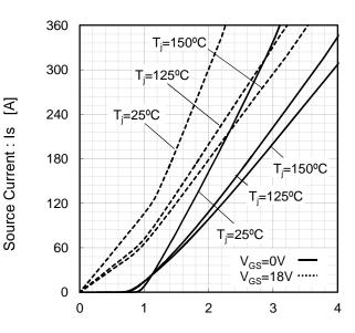
Source-Drain Voltage: V<sub>SD</sub> [V]
