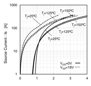
Source-Drain Voltage : V<sub>SD</sub> [V]
