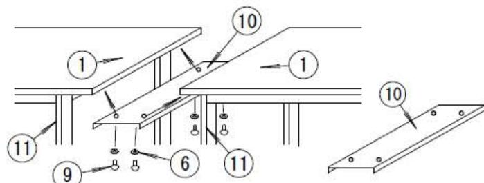
2台並べて天板①と天板①のつなぎの部分に連結金具⑩を当て、穴を天板①のナット位置に合わせて、トラスネジ⑨とSW⑥で取り付けて下さい（4カ所）。
