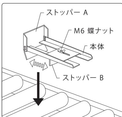
蝶ナットを緩め、ストッパーBをフリーな状態にします。ストッパーAとストッパーBで、ローラーを挟み、蝶ナットを締め付け、ポータブルストッパーが、はずれないよう確実に装着してください。
