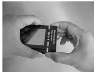
3. センサーヘッドを強く差し込み、本体とセンサーヘッドの間に隙間が無いことを確認してください。
