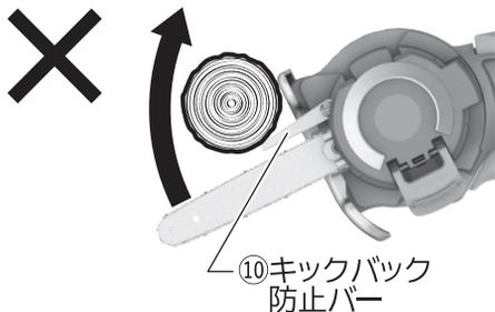
☞ キックバック防止バー⑩は、切断中に刃先が材料に挟まれて跳ね返るキックバックを回避するために設けてあります。
