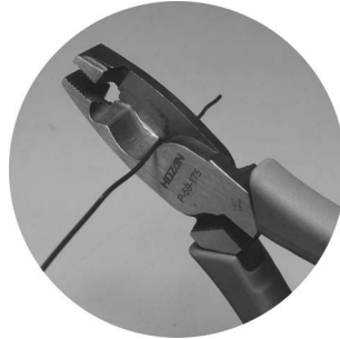
鉄バインド線の切断
