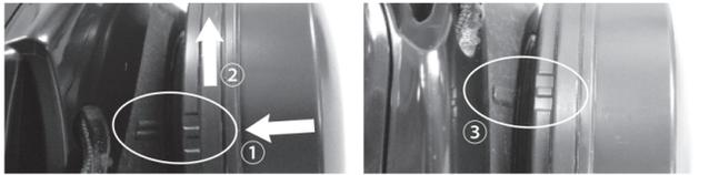
**警告** ろ過材(又は吸気缶)が面体に正しく取り付けられていることを確認してください。平行に押し当てて回さないと、ろ過材(又は吸気缶)が斜めに取り付け、粉じん(又はガス等)が侵入します。
