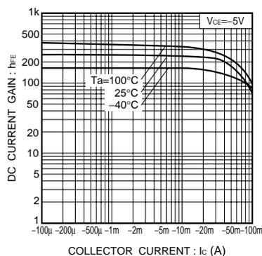
Fig.1 直流電流増幅率
