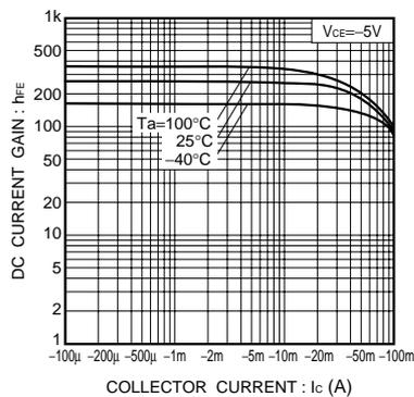
Fig.1 直流電流増幅率
