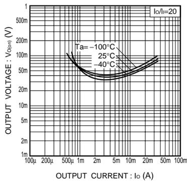
Fig.4 出力電圧 - 出力電流特性
