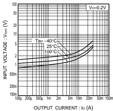
Fig.1 入力電圧 - 出力電流 (ON特性)
