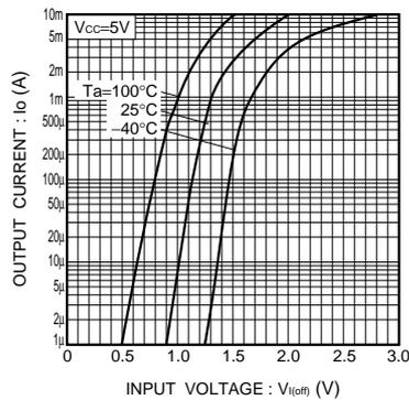
Fig.2 出力電流 - 入力電圧 (OFF特性)
