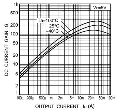
Fig.3 直流電流増幅率 - 出力電流特性
