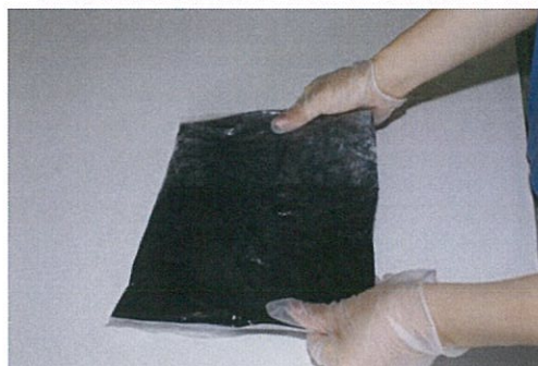
⑥樹脂の外観が均一になるまで混ぜて下さい。
