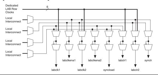
Figure 2-7. LAB-Wide Control Signals
