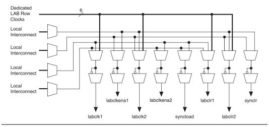
Figure 2-7. LAB-Wide Control Signals
