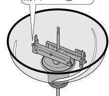
②山おとし刃を上下に移動させながら、 主刃上の目盛Aに寸法aを合わせる 寸法a=b(天井材の厚み)-c(山おとし深さ)
