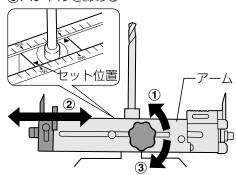
●ハンドルは図のようにカバーを押し下 げて、確実に締め付けてください。
