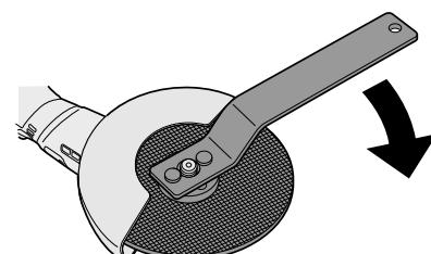
※トイシ外径(φ 100 mm)締め付け時のイラストとなっております。
