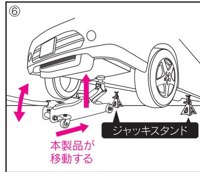
⑥ ハンドルを上下に動かしてサドルを上昇させ、ジャッキスタンドが車両の左右ジャッキセット位置に入るまでジャッキアップする。ジャッキアップ時に本製品が移動しているか確認しながら作業を行ってください。万が一、移動していなければ作業を中止し、ジャッキアップしている場所の確認をしてください。
