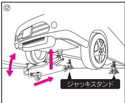
⑫ 作業後、再びジャッキをジャッキセット位置まで移動させ、リリースバルブを右回り(時計回り)に回してリリースバルブをしっかり締め、ジャッキスタンドが取りはずせる位置までジャッキアップする。
