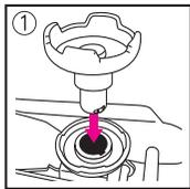
① 高さ調整用サドルを通常のサドルの穴位置にセットする。
