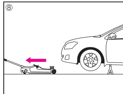
⑧ ジャッキスタンドが、車両を完全に維持しているのを確認し、ジャッキのサドルを下げて移動させる。
