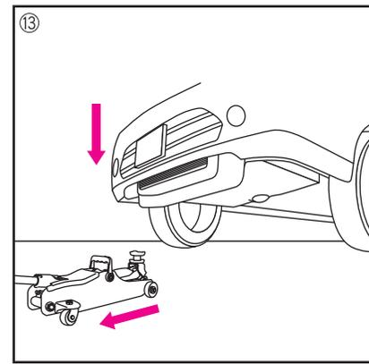
⑬ 車両の下に入れてあるジャッキスタンドをはずし、リリースバルブを左回り(反時計回り)にゆっくり回しジャッキダウンする。
