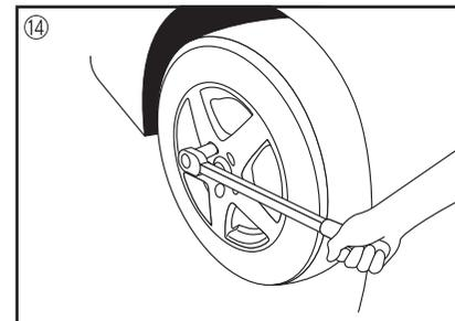
⑭ ジャッキを安全な所まで移動してから、トルクレンチを使用し、規定のトルク数値でホイールナットを本締めする。
