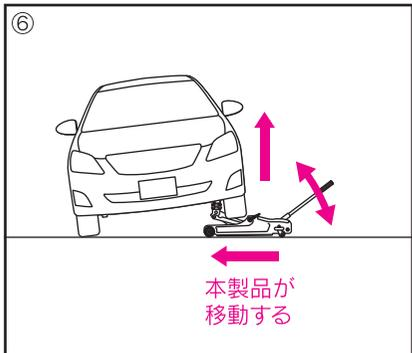
⑥ ジャッキアタッチメントがジャッキセット位置に確実に接触しているか確認後、ハンドルを上下に動かし、ジャッキアップする。ジャッキアップ時に本製品が移動しているか確認しながら作業を行ってください。万が一、移動していなければ作業を中止し、ジャッキアップしている場所の確認をしてください。
