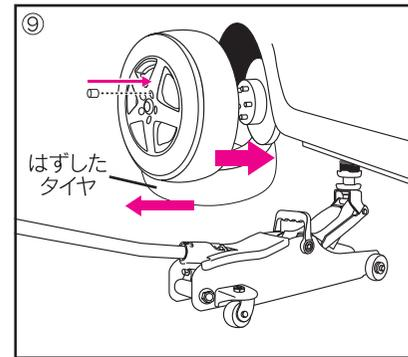
⑨ 交換用タイヤを取り付け、ホイールナットを手で回して取り付けした後、クロスレンチ等を用いて仮締めし、車両の下に敷いたタイヤを取り出す。
