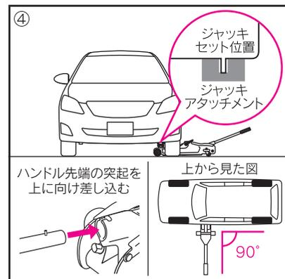
④ ハンドルをハンドルスリーブに差し込み、ジャッキアタッチメントを載せたサドルを、車両のジャッキセット位置\*の下まで入れ、ジャッキアタッチメントがジャッキセット位置に軽く接触するまでハンドルを上下に動かしサドルを上げる。
