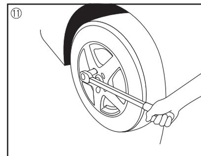
⑪ ジャッキを安全な所まで移動してから、トルクレンチを使用し、規定のトルク数値でホイールナットを本締めする。
