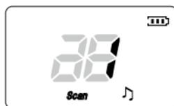
スキャン中に有効な信号を受信すると、そのチャンネルで一時停止します。その際に PTT スイッチを押すとそのチャンネルで送受信ができます。一時停止した後、送受信をしない時間が5秒経過するとスキャンが再開されます。
