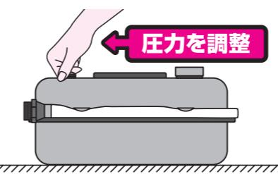
警告 内部の圧力を調整せずに給油キャップを開けると中身がふき出る恐れがあり非常に危険です。必ず圧力を調整してください。
