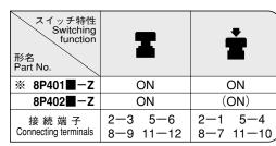
※印スイッチ特性は押すたびに回路が切換わる \*Circuit changes whenever pushed.
