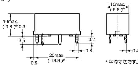
●動作表示灯 + サージ吸収用ダイオード内蔵形(標準端子形)
