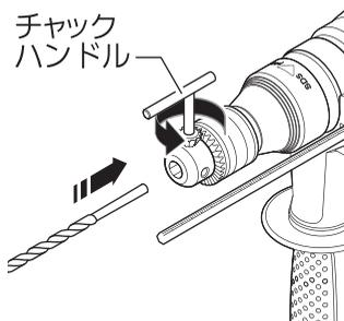
3. 先端工具をチャックに差し込みます。
