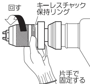
2. 先端工具をチャックに差し込みます。
