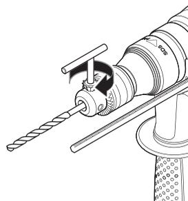
キーチャック外周にはチャックハンドルを差し込む穴が3つあります。3か所で均等に締めてください。3か所で締めないと、先端工具のつかみ具合が不十分になります。
