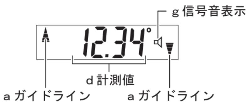
水平または垂直が出ると、ガイドライン a の表示が消え、信号音を“入”にしている場合は信号音が継続して鳴ります。信号音は、「信号音ボタン⑱ (🔊)」を押すと止まります。
