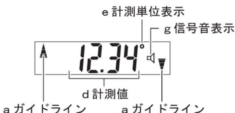
2. 計測器を設置し、ディスプレイ⑦の計測値 d に設定したい角度が表示されるまで計測器を傾けます。
