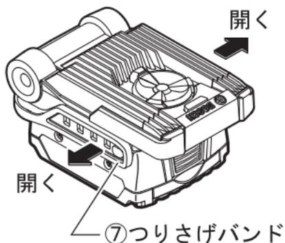
2. 本体のつりさげバンド用フック⑥につりさげバンド⑦の長さ調節用穴を差し込み、任意の長さに調節します。
