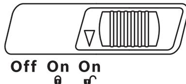
電源が入ると、本器はレーザーラインを照射し、自動整準を行います。(自動補正範囲が $4^{\circ}$ 以内の場合)
