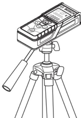
三脚取り付け用アダプターを使用した場合も、計測の基準点は計測機本体の後端部になります。
