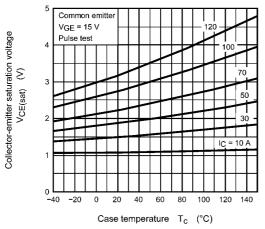
Fig. 8.9 V<sub>CE(sat)</sub> - T<sub>c</sub>
