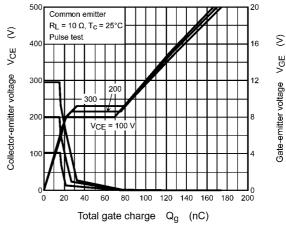
Fig. 8.16 V<sub>CE</sub>, V<sub>GE</sub> - Q<sub>g</sub>
