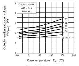
Fig. 8.5 V<sub>CE(sat)</sub> - T<sub>c</sub>
