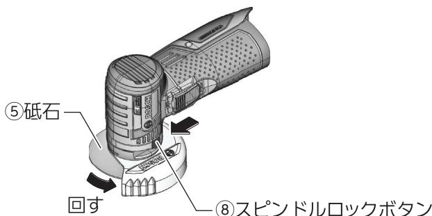
2. 六角棒レンチ(4mm)を使用して、フランジ付き固定ボルトを取り外し、砥石⑤を取り外します。
