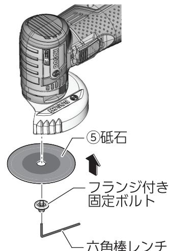
6. スピンドルロックボタン⑧を電動工具本体の後方にスライドさせて、ロックします。
