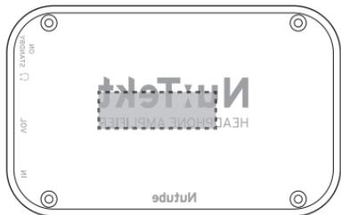
9. 端子名が印刷されている側を端子側にしてカバー [3]をかぶせ、4か所を六角穴付きボルト[4]で止めます。
