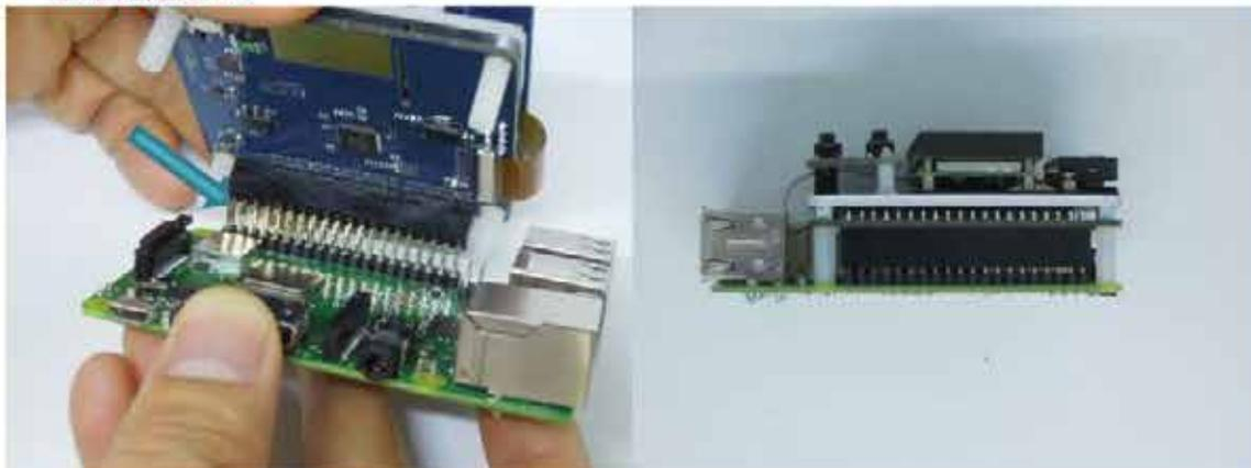
ステップ⑧: Raspberry Pi 3 Model B+と組立てたアダプタボード(A)を樹脂スペーサ(H)で固定します。(4か所)
