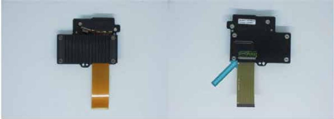
ステップ②：スペーサ(G)を使ってベースプレート(B)とアダプタボード(A)を固定します。(4か所)
