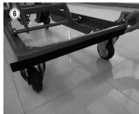
⑥ 下側の枠にも各辺にマジックテープ(メスのみ)を貼る。 ※ハンドル面下側は取付けなし
