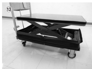
⑬ 下側取り付け後、天板へのマジックテープの取り付けをやすくするため、ハンドリフターを下降させる。
