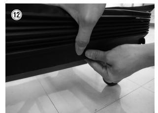
⑫ 剥がれないようしっかりとマジックテープのオスをメスを貼り合わせる。
