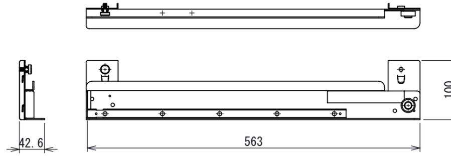
部品①引出し棚 最大突出寸法
