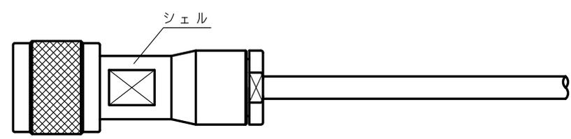
4 シェルを装着し、締付ナットをスパナ等で締め付けて作業を完了する。
