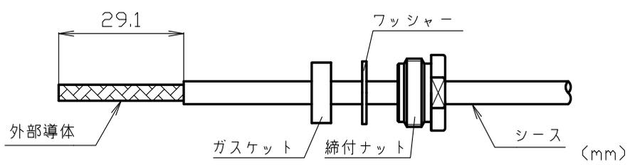
1 同軸ケーブルへ締付ナット、ワッシャー、ガスケットの順に通し、シースを図中の寸法で切りとる。
