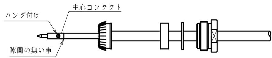
3 内部導体に中心コンタクトを装着しハンダ付けする。この時、絶縁体と中心コンタクト間に隙間がないこと。
