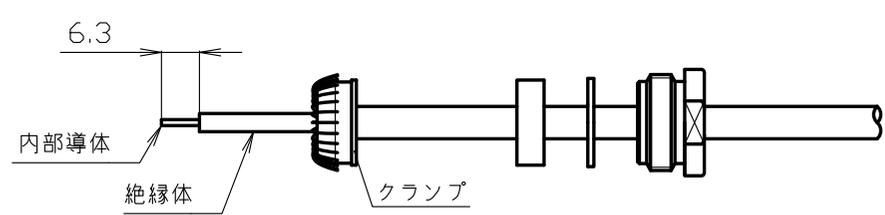
2 クランプを装着し、外部導体を綺麗にほぐし折り返して切りそろえ、絶縁体を図中の寸法で切りとる。
