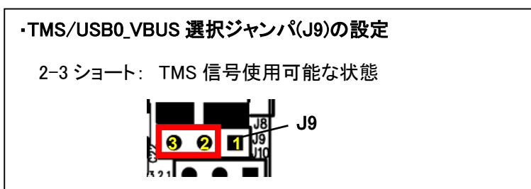
図 2-5 TMS/USB0_VBUS ジャンパ設定図(J9)
