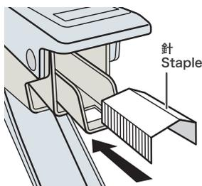
**3** プッシャを本体に押し込むと、針が定位置にセットされ、準備完了します。
