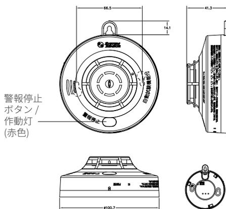
HS-JV2-N 光電式 製品寸法図
