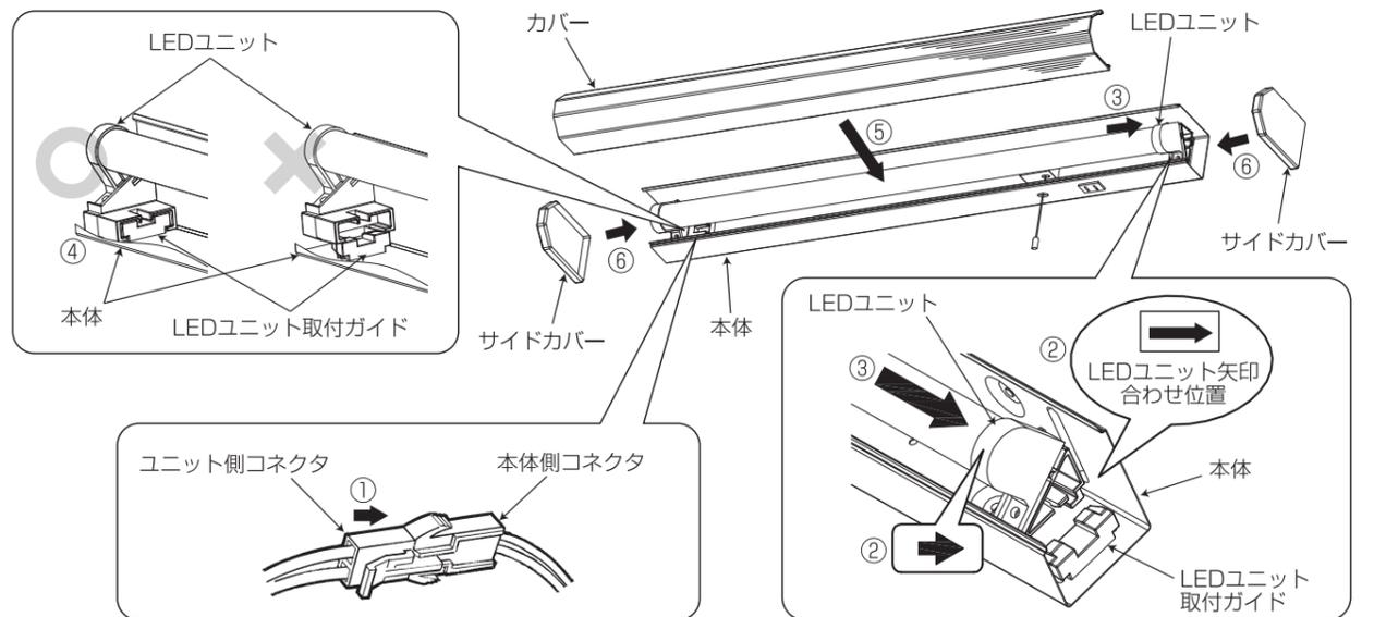
**警告** 落下・破損のおそれあり。取り付けが不完全な場合、落下によるけがの原因となります。
