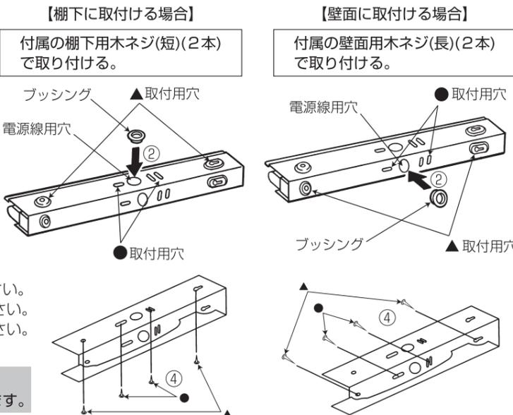
**重要ポイント** 必ず2ヶ所でネジ止めしてください。取付けが不完全な場合、落下によるけがの原因となります。
