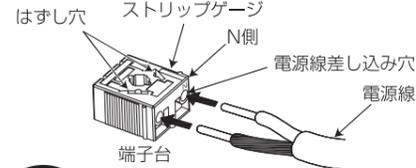
電源線ははずす場合必ず電源を切ってからマイナスドライバー等をはずし穴に差し込み電源線を引き抜いてください。
