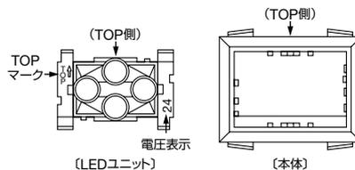
G（緑色）を使用している長軸2分割および2色切替え（赤↔緑）照光タイプのLEDユニットを取り扱う場合はLEDユニットの金属フレーム切断部（下図参照）に直接手が触れて静電気が加わらないようにご注意ください。この部分に静電気が加わりますとLED素子を破壊する恐れがあります。
