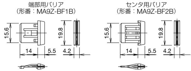
• 本体の装着時の寸法は P16 の取付穴加工図をご覧ください。
