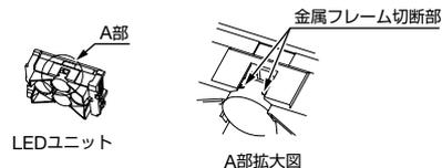
また、アクセサリ保守対応品では、金属フレーム切断部に直接手が触れて静電気が加わることを防ぐため保護用にシールを貼っておりますので、交換直前にシールを取り外してご使用ください。
