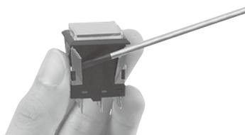
たて取付け用ばねのかん合部と本体のかん合部を合わせるように仮挿入し、きっちりかん合するまでたて取付け用ばねを押し込むと取付けできます。
