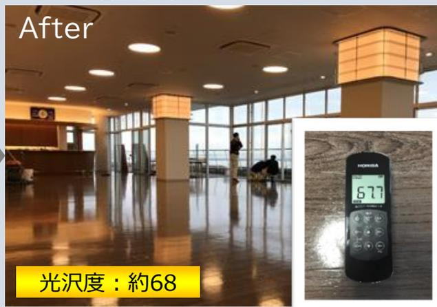
上の写真のように、ワックスを2層塗布した状態と6層塗布した状態では、床面で反射する照明の像の鮮明さからも、光沢に差があることがわかります。
