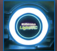
充電バランス調整(点滅) 溶接中(点灯)
