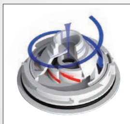
シャワーヘッド内部の旋回流
