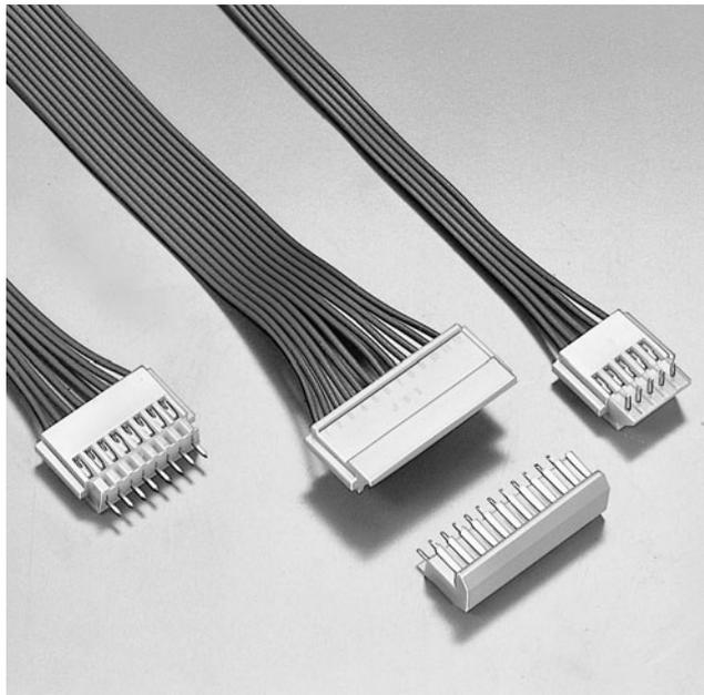
プリント基板と電線を接続するための2.5mmピッチのコネクタでコンタクト、ハウジング、ベース付ポストにより構成されています。ベース付ポストにはトップ型、サイド型、ボトム型の3種類があり、これらを組み合わせることにより基板に対して直角(上、下)平行の3方向に電線を引き出すことができます。
