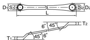
立ち上がり角は狭い場所でも使いやすい45° x 6°を採用。オフセット高ささと長さを抑え、狭い場所での使い勝手をよくすると同時に、ボルト・ナットに効率よく力を伝えます。柄は、しなりに強く、軽量化も図れる形断面形状です。サイズ表示は大きく見やすい鍛造浮き出し刻印です。
