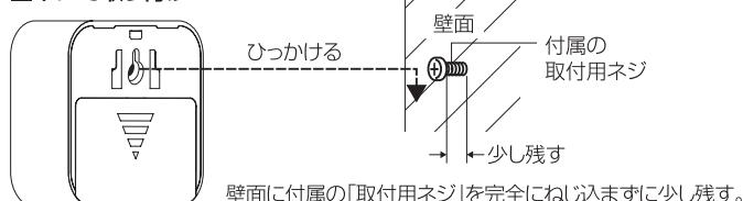
ご注意 金属面や金属製品の近くに取り付けると電波到達距離が短くなります。
