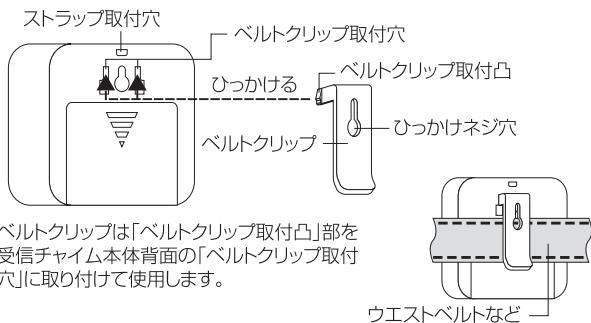
ベルトクリップは「ベルトクリップ取付凸」部を受信チャイム本体背面の「ベルトクリップ取付穴」に取り付けて使用します。
