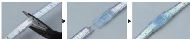
補修が必要な箇所をカッター(50cm毎)で切断します。
