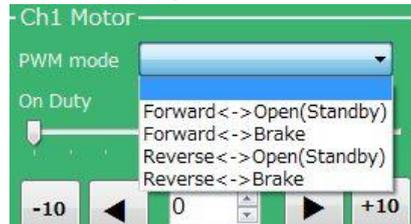
モータが回転している最中に回転方向を切り替える場合は、一旦BrakeボタンかOpenボタンを押してから切り替えることを推奨します。
